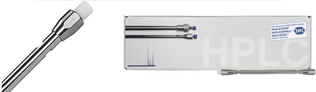
Colonne HPLC EC analytique en phase inverse, en acier inoxydable
