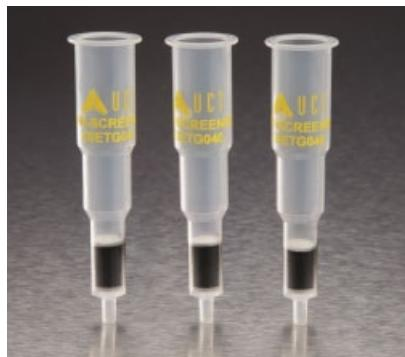
Colonnes SPE Clean Screen® ETG d'extraction phase solide
