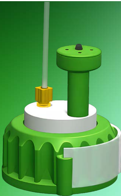
Étiquette d'identification amovible , pour indiquer l'éluant dans la bouteille.
