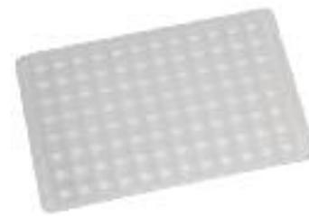
Tapis de fermeture pour plaque à 96 puits de 2 ml
