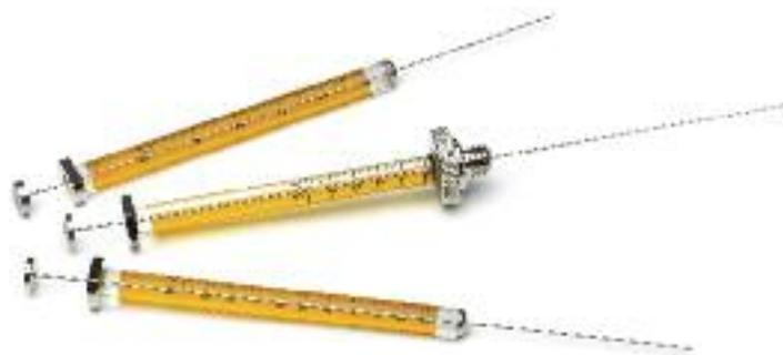
**Seringues pour injecteurs automatique d'échantillons des systèmes de CPG de Thermo, 1/pqt**
