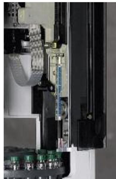
Seringue Agilent gamme Bleue pour injecteur automatique représentée dans l'injecteur automatique d'échantillons 7693, G4513-80204A
