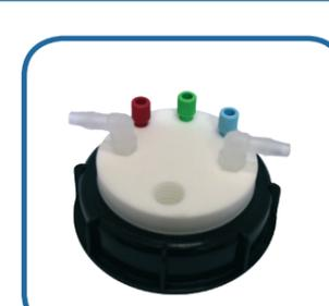
CC-SW90-3-C-2L : Raccords universels 2 en 1 1/8", 2 raccords leak et un filetage pour charbon actif
