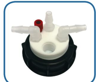
CC-SW55-1-C-3L : 1 écrou 1/8", 3 raccords leak et un filetage pour charbon actif
