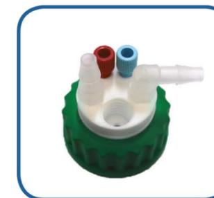
CC-SW45-2-C-2L : 2 Raccords universels 2 en 1 1/8", 2 raccords leak et un filetage pour charbon actif
